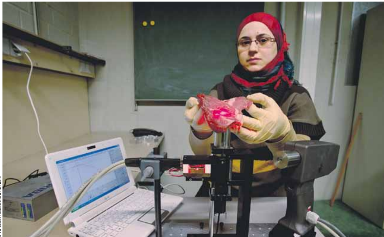
Doktorandin Halah Al-Ebrahim demonstriert, wie das Fleisch mit rotem Laserlicht untersucht wird. Das Messgerät, das hier zu sehen ist, konnte so verkleinert werden, dass es in die handliche „Laserpistole“ passt. Auf dem Laptop wird die Kurve sichtbar, die bei jeder Fleischsorte anders ist
