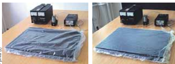
Das Vakuum in einer Folie führt zu besonders hohen schalldämmenden Effekten
