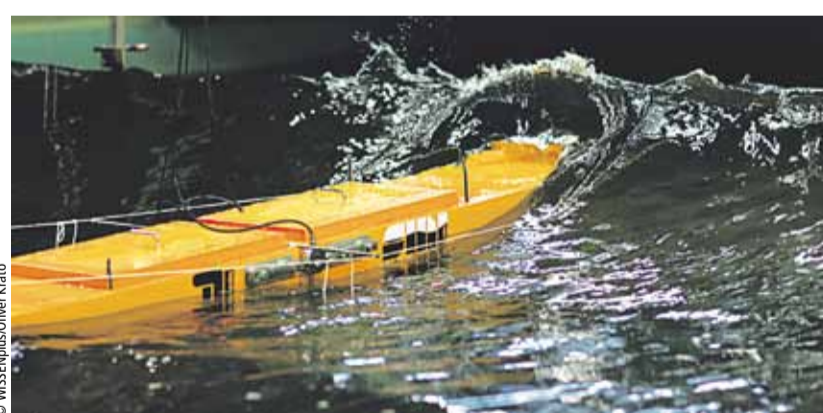
Versuch zum Einschlag einer Extremwelle – die sogenannte „New Year Wave“ – auf den Bug eines Massengutschiffes
