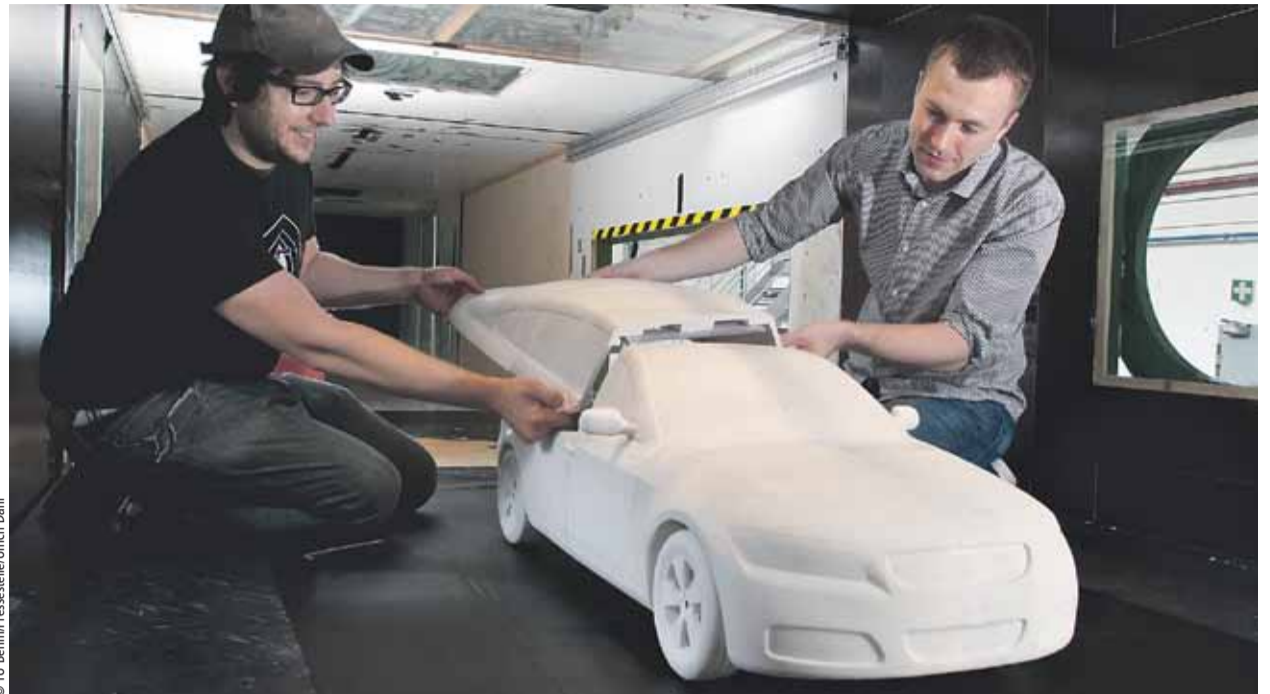
Der Student Hanns-Joachim Schmidt (l.) und der wissenschaftliche Mitarbeiter Dirk Wieser montieren das neue Automodell „DrivAer“ für mehrere Messreihen im Windkanal der TU Berlin. Das Modell wurde im Institut für Mathematik „ausgedruckt“
