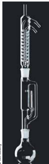
Der Schlangenkühler: Wärmetauscher für die Anwendung im Labor
